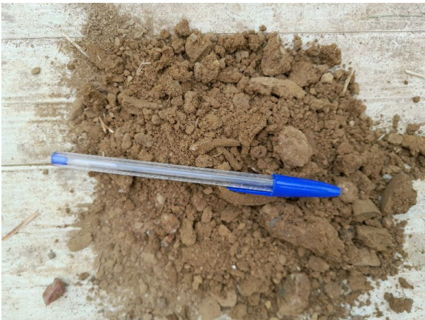
Sol : limon argileux T1 : sol prélevé entre 0,2 et 1,6 m
