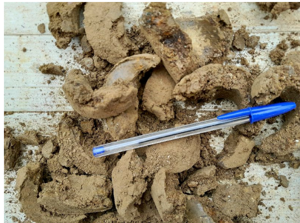
Sol : limon argilo-graveleux T1 : sol prélevé entre 1,6 et 3,0 m.
