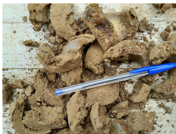
Limon argileux à graviers Tarière T1 entre -1,6 et -3,0 m/TN
