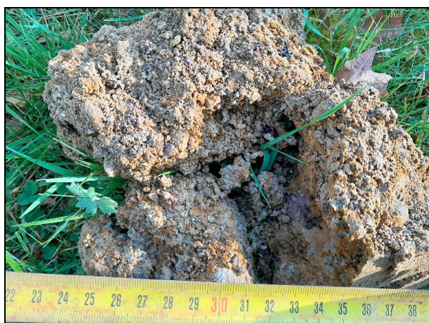
Sol : Argile limoneuse +/- bariolée, hydromorphies P2 entre 0,3 et 0,7 m
