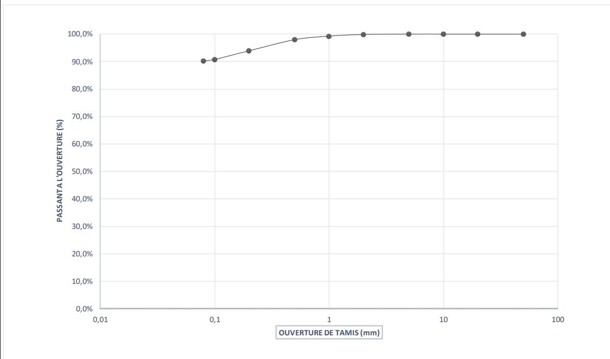
fraction 0/2mm dans la fraction 0/50mm **99,9%**
